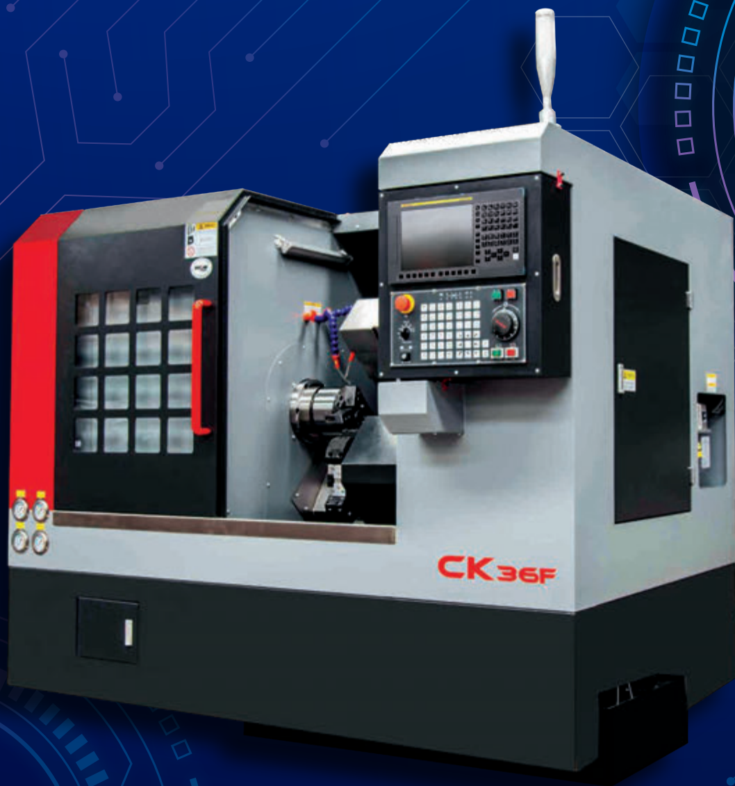
Torno CNC de Herramientas vivas Modelo: CK-36F
